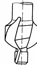
/5.04d/ Formsenker mit festem Führungszapfen
